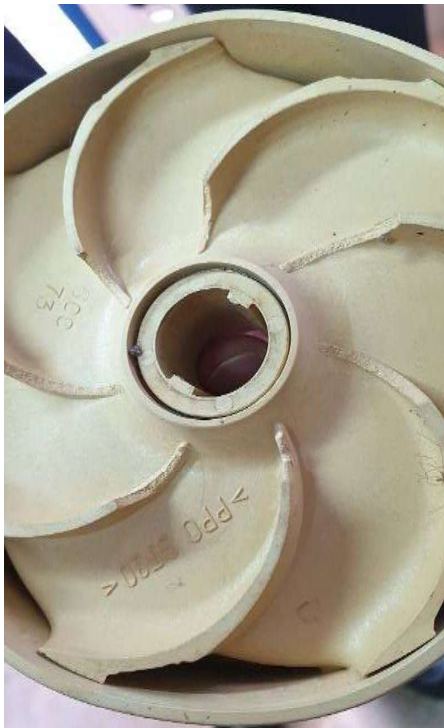
Slika 2. Prikaz oštećenih lopatica pumpe
